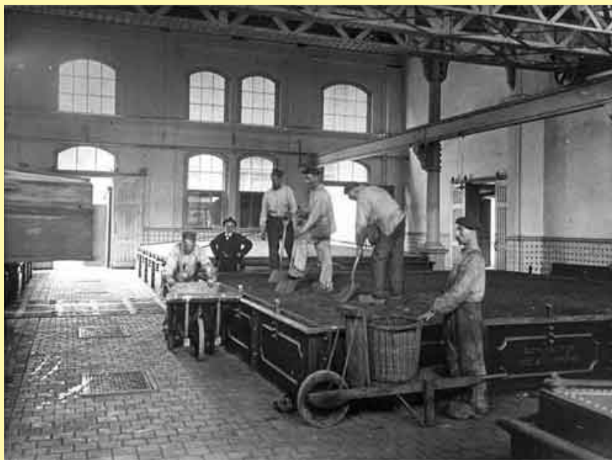
Het in de gasfabriek geproduceerde steenkoolgas werd door grote kisten met ijzeraarde gevoerd om het te ontdoen van zwavelverbindingen. Regelmatig moest de vulling van de kisten worden vervangen door nieuwe.
